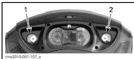
1. Indicateur de température de liquide de refroidissement
