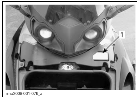
1. Sikringsboks plassert under servicedekslet bak oppbevaringsrommet foran
