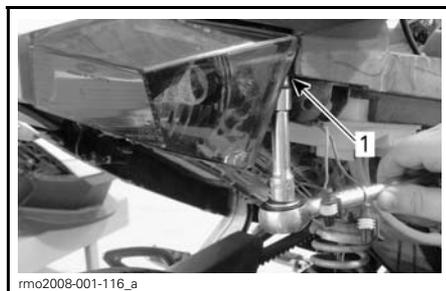
1. Retirez la vis Torx derrière la lentille
