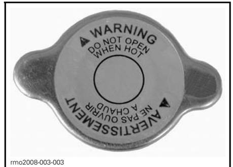
**BOUCHON DU RÉSERVOIR DE LIQUIDE DE REFROIDISSEMENT**
