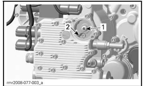
1. Orifice de sortie allant au système de lubrification du module de commande hydraulique
