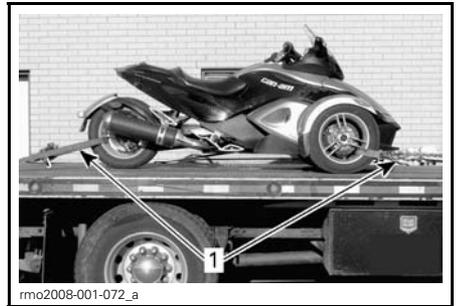
1. Roues avant et arrière solidement arrimées à la semi-remorque
