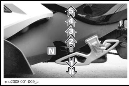
Soulevez le levier de changement de vitesses ou appuyez dessus pour passer d'une vitesse à l'autre. Lorsque vous relâchez le levier, il retourne automatiquement en position centrale où le mécanisme est réinitialisé en vue de la prochaine sélection. Pour sélectionner le point mort (N), soulevez le levier de changement de vitesses à mi-chemin vers le haut ou appuyez à mi-chemin depuis la deuxième vitesse. Consultez la section *CHANGEMENT DE VITESSES* pour des consignes d'utilisation détaillées.
