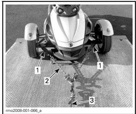
1. Mettez la courroie autour des bras inférieurs de suspension avant
