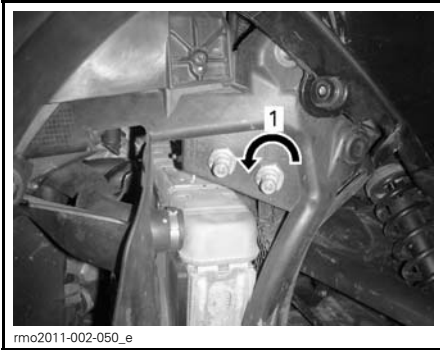
AFSTELKABEL RECHTERKOPLAMP 1. Lichtbundel van de koplamp verhogen
