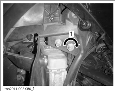
AFSTELSCHROEF 1. Lichtbundel van de koplamp verlagen
