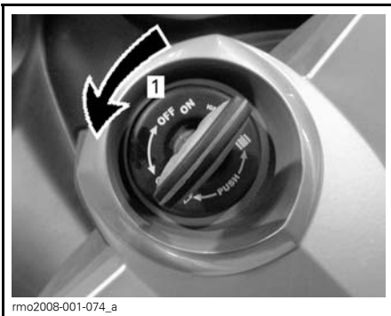
STAND VAN DE SLEUTEL OM HET STUUR TE VERGRENDELEN
