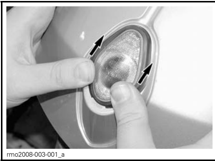
4. Trek de lamp uit de fitting als hieronder aangegeven.
