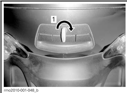
1. Tournez dans le sens horaire pour verrouiller
