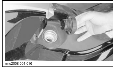
BOUCHON DE REMPLISSAGE À GAUCHE SOUS LE SIÈGE
