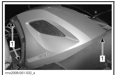
1. Klemmen van het middelste zijpaneel
