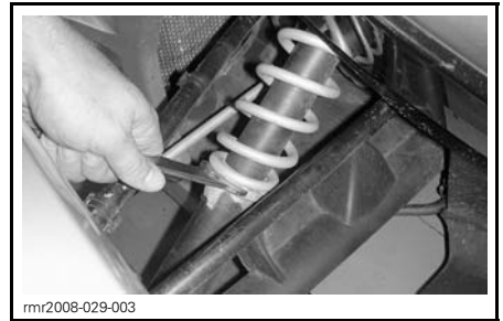
mmr2008-029-003 AFSTELLING VAN DE NOK VAN DE VOORWIELOPHANGING
