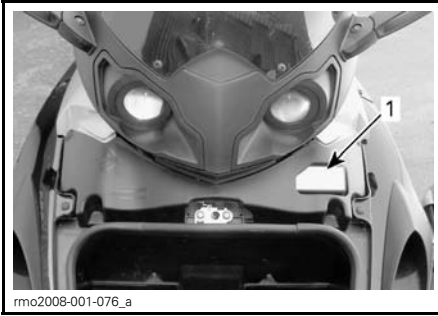
1. Sulakkekotelo huoltokannen alla, etutavaratilan takana
