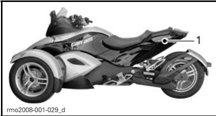
1. Batterie hinter der linken hinteren Seitenverkleidung
