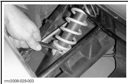
rmr2008-029-003 EINSTELLUNG DES NOCKENS DER FEDERUNG VORN
