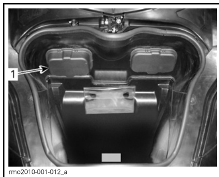
1. Caixa de fusíveis no bagageiro dianteiro
