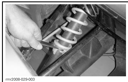
RÉGLAGE DE LA CAME DE SUSPENSION AVANT
