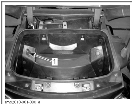
1. Tomada de energia
