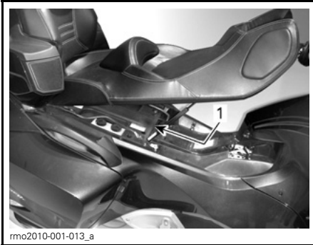
1. Sicherungskasten unter dem Sitz
