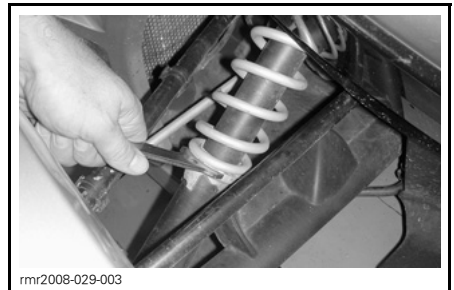
EINSTELLUNG DES NOCKENS DER FEDERUNG VORN
