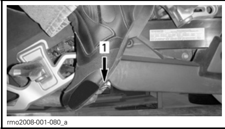
1. Ein- und Ausrücken des Feststellbremspedals
