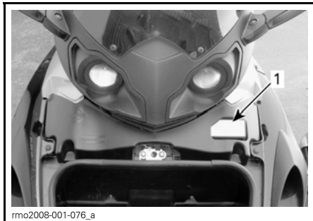
1. Caixa de fusíveis localizada sob a tampa de manutenção, atrás do compartimento de bagagem
