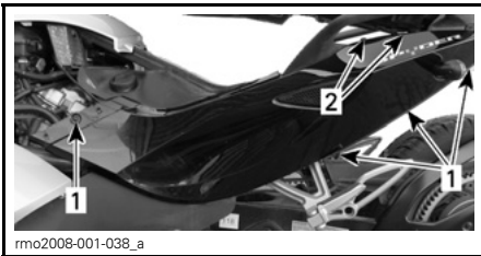
1. Torx-schroeven 2. Plastic klinknagels
