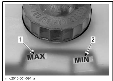
1. Brake fluid MAX. level mark 2. Brake fluid MIN. level mark
