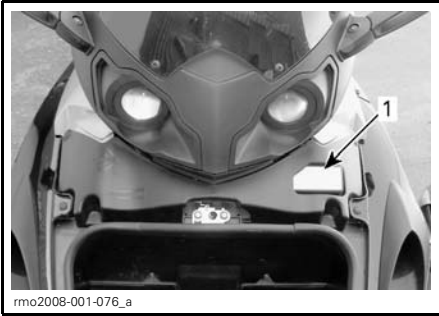
1. Boîte à fusibles située sous le couvercle de service derrière le compartiment de rangement avant
