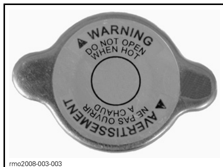
TAMPA DO DEPÓSITO DO LÍQUIDO DE ARREFECIMENTO
