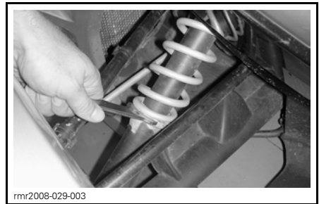
AJUSTE DA CAME DA SUSPENSÃO DA FRENTE
