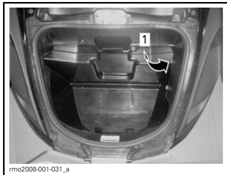
1. Caixa de ferramentas localizada na caixa de carga da frente
