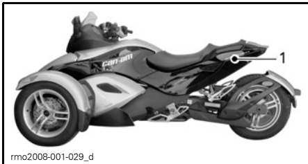
1. Batterie hinter der linken hinteren Seitenverkleidung
