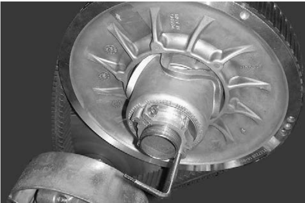
TYPEBILDE – FORLENGER FOR DRIVREIMSKIVE MONTERT PÅ JUSTERINGSNAV
