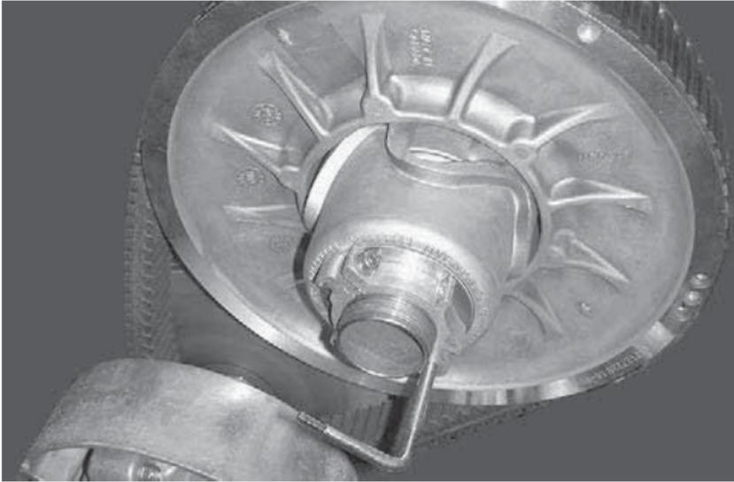
**TYPISCH - SCHEIBEN-EXPANDER AN NABE DER EINSTELL-VORRICHTUNG MONTIERT**
