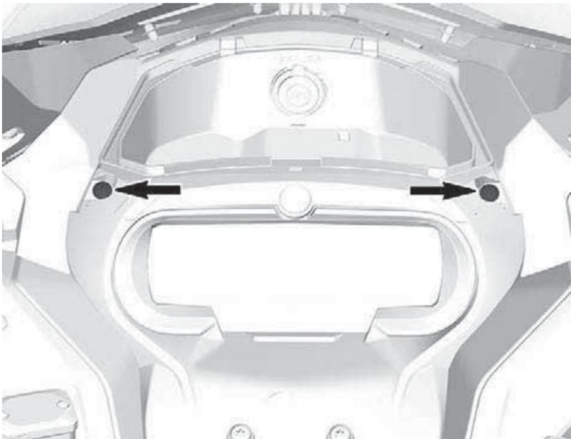
4. Heben Sie die Vorderseite der Anzeiginstrumenthalterung an und schieben Sie diese anschließend nach vorne, um sie abzunehmen.
