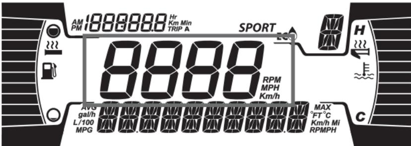
Zeigt die Drehzahl des Motors oder die Fahrzeuggeschwindigkeit in Km/h oder MPH an.
