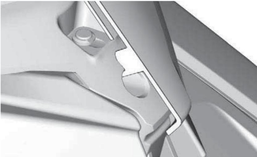
3. Befestigen Sie die Windschutzscheibe, indem Sie deren Stifte in die Durchgangsstellen stecken.
