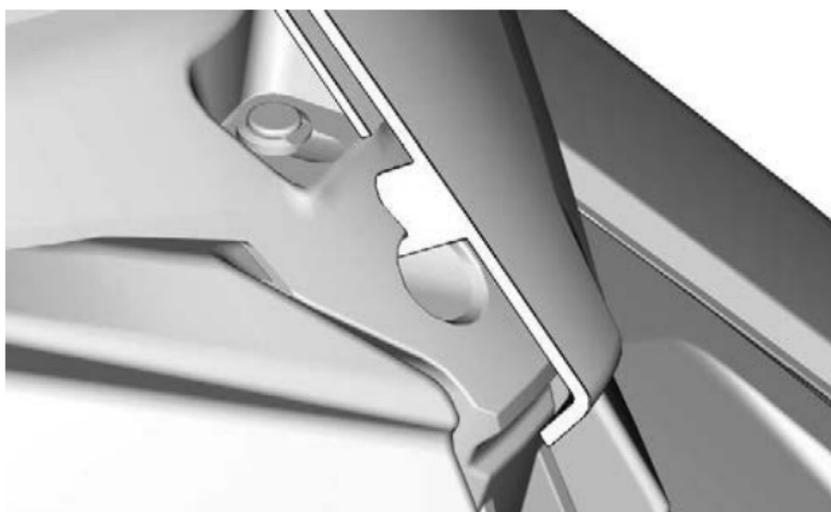
3. Fissare il parabrezza inserendo i perni del parabrezza nelle guarnizioni.
