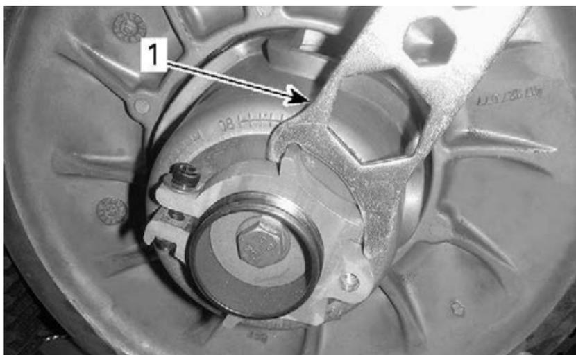
1. Strumento di regolazione delle sospensioni
