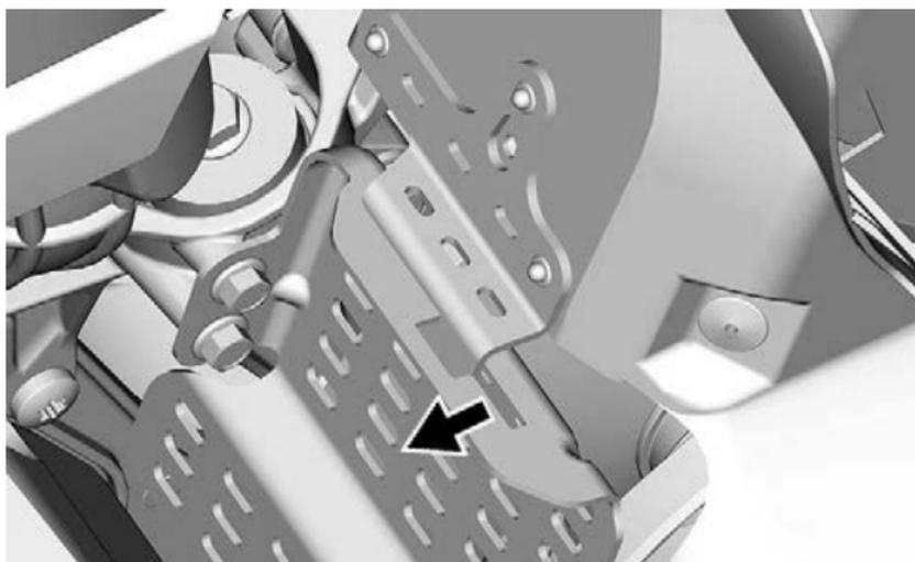
Posizionare la parte posteriore della protezione cinghia sopra il fermo e assicurarla mediante il perno di blocco.
