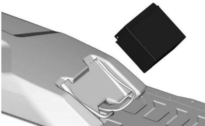
***Installazione della batteria***
