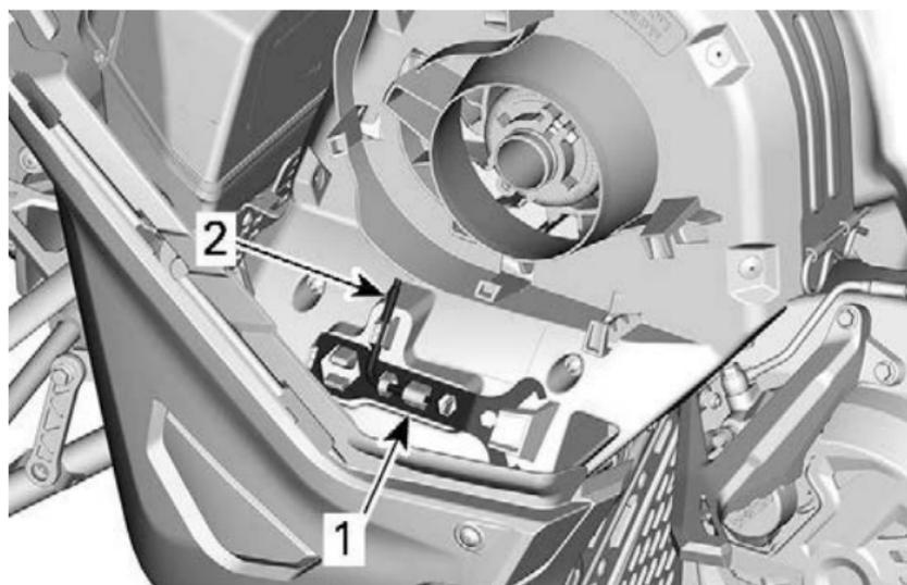
**CONFIGURAZIONE TIPICA - POSIZIONE DEGLI STRUMENTI PER LA PROTEZIONE DELLA CINGHIA DI TRASMISSIONE**
