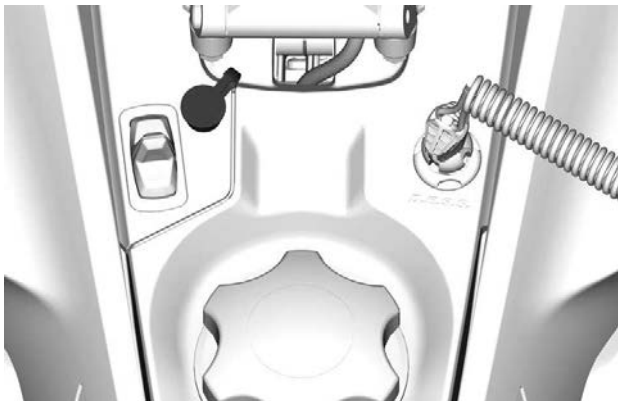
CONDUCTEUR - EMBLACEMENT PRISE DE VISIÈRE ÉLECTRIQUE
