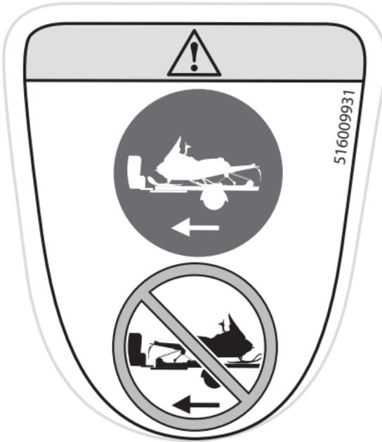
**KORREKTE ABSCHLEPPRICHTUNG – WARNSCHILD**
