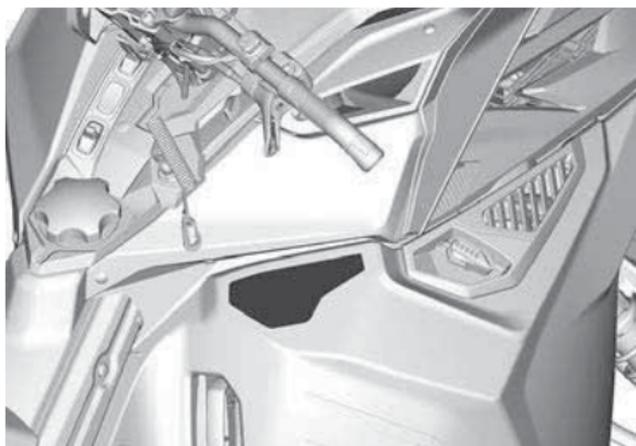
**Korrekte Abschlepprichtung – Warnschild**
