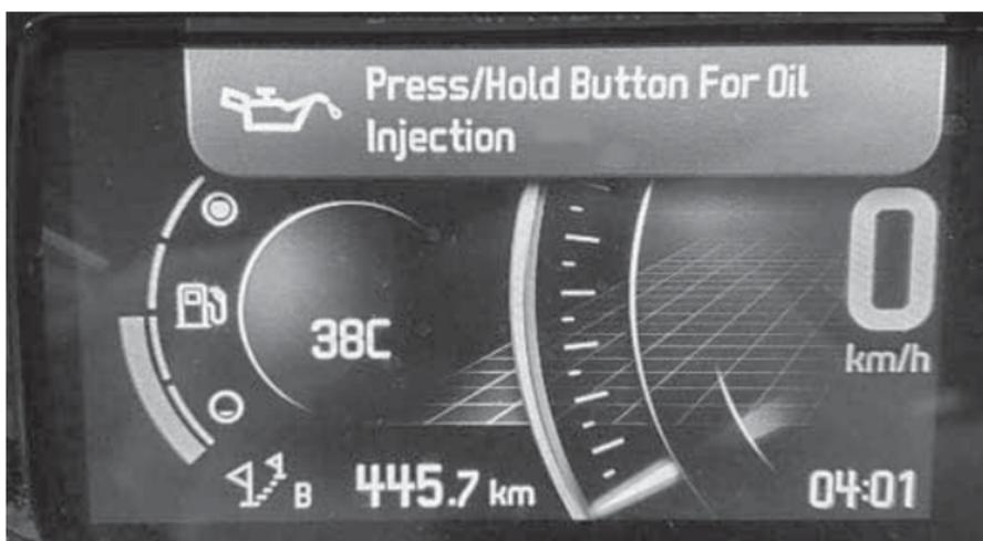
5. Lassen Sie alle Tasten los, wenn das Anzeigeelement die Meldung anzeigt.
