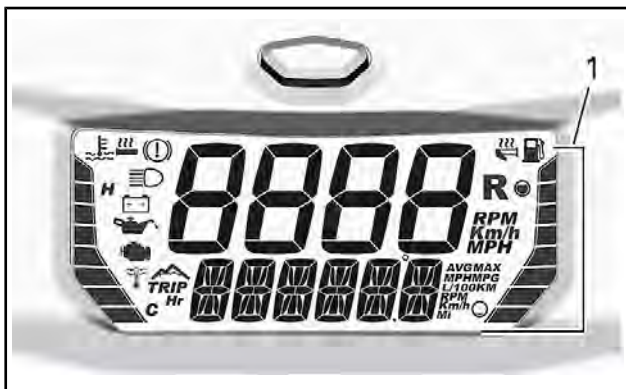
1. Søylemåler høyre side
