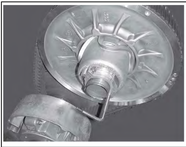
TYPBILD - VARIATORUTVIDGARE INSTALLERAD PÅ JUSTERINGSNAVET
