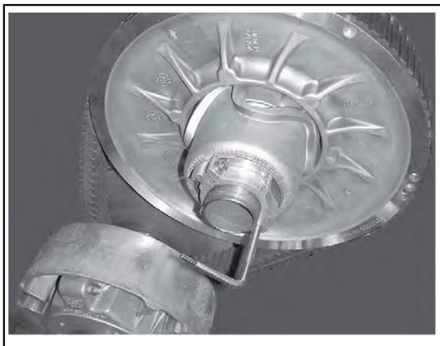
TYPBILD - VARIATORUTVIDGARE INSTALLERAD PÅ JUSTERINGSNAVET
