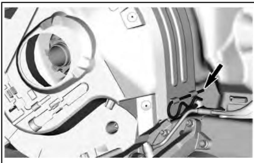
Heben Sie den hinteren Teil der Abdeckung an und lösen Sie sie dann von der vorderen Lasche.
