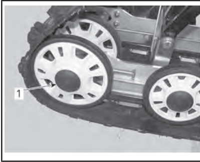
1. Колпачок правого заднего направляющего катка
