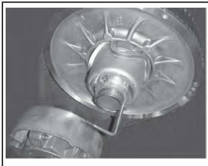
ПРИСПОСОБЛЕНИЕ ДЛЯ РАЗВЕДЕНИЯ ШКИВА ВСТАВЛЕНО В РЕГУЛИРОВОЧНУЮ МУФТУ
