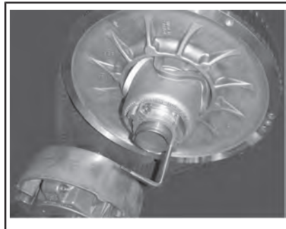
SCHEIBEN-EXPANDER AN NABE DER EINSTELLVORRICHTUNG MONTIERT
