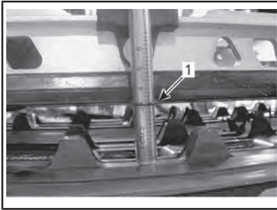
1. Durchbiegungs-O-Ring mit Gleitschuh ausgerichtet
