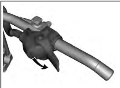
GASHEBELPOSITION FÜR DAUMENBETÄTIGUNG: ZUM DREHEN DES GASHEBELGEHÄUSES NACH UNTEN DRÜCKEN
