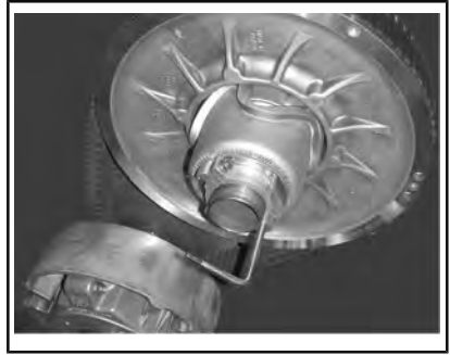
SCHEIBEN-EXPANDER AN NABE DER EINSTELLVORRICHTUNG
