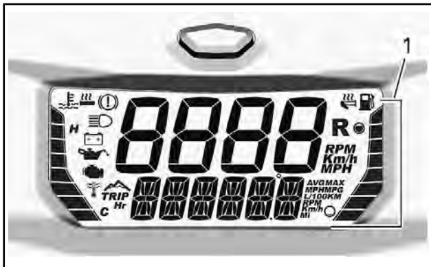
1. Søylemåler høyre side
