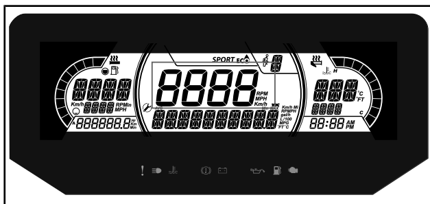
Отображение скорости транспортного средства в км/ч (или милях/ч) или частоты вращения двигателя в об/мин. См. раздел «НАСТРОЙКИ».
