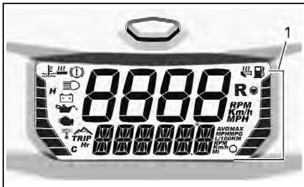
1. Søylemåler høyre side
