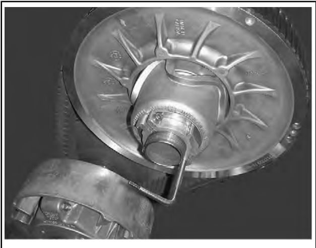
TYPEBILDE – FORLENGER FOR DRIVREIMSKIVE MONTERT PÅ JUSTERINGSNAV
