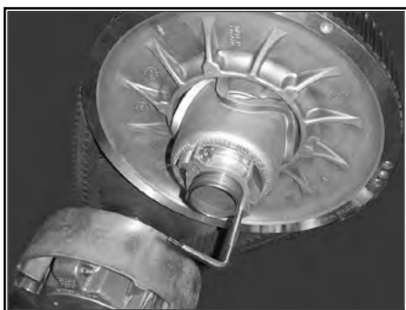
ПРИСПОСОБЛЕНИЕ ДЛЯ РАЗВЕДЕНИЯ ШКИВА ВСТАВЛЕНО В РЕГУЛИРОВОЧНУЮ МУФТУ
