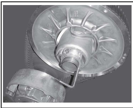
VARIAATTORIN AVAUSTYÖKALU ASENNETTUNA SÄÄTIMEN NAPAAN
