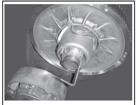
SCHEIBEN-EXPANDER AN NABE DER EINSTELLVORRICHTUNG MONTIERT
