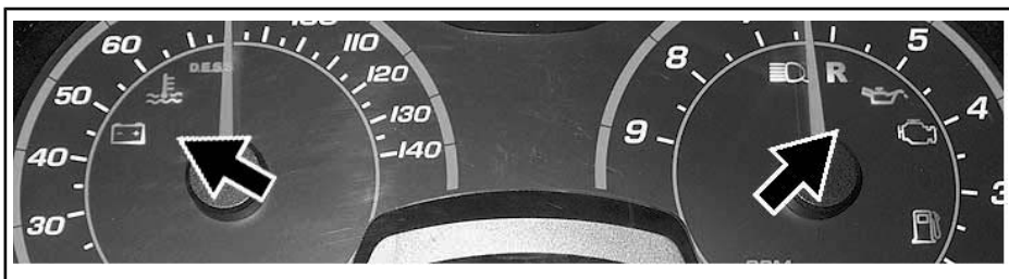
BILDET VISER – KONTROLLAMPER
