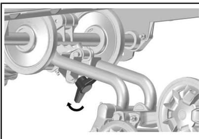
**TOURNEZ LA POIGNÉE À FOND DANS LE SENS DES AIGUILLES D'UNE MONTRE - SUSPENSION PLUS FERME**
