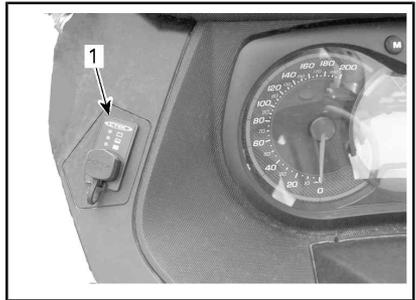
1. Affichage la batterie/prise de mise en charge
