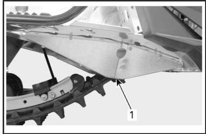
1. Trou d'accès du bouchon de remplissage
