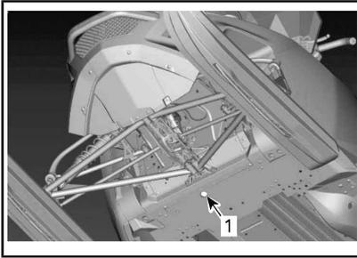
1. Ouverture du châssis pour atteindre le bouchon de vidange
