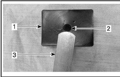
1. Butée d'arrêt de caoutchouc
