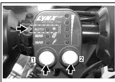
Pour utiliser les valeurs présélectionnées, appuyez sur le bouton gauche jusqu'à ce que la LED AUTO s'allume. Appuyez sur le bouton droit pour définir la précharge du ressort et la force d'amortissement présélectionnées. Vers le haut,
