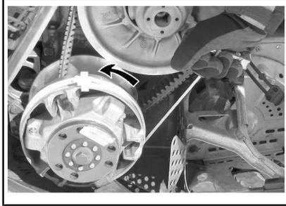
6. Tirez sur la corde d'un mouvement ferme et sec, de sorte que la corde se libère de la poulie d'entraînement.
