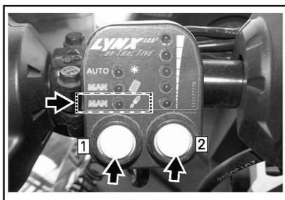
Pour augmenter ou réduire l'amortissement, appuyez sur le bouton gauche jusqu'à ce que la LED MAN/amortisseur s'allume. Appuyez sur le bouton droit pour régler l'amortissement; vers le haut pour plus d'amortissement et vers le bas pour moins d'amortissement.
