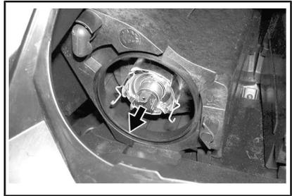
RETIREZ L'AMPOULE ET REMPLACEZ-LA
