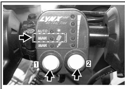
Pour ajuster la précharge du ressort, appuyez sur le bouton gauche jusqu'à ce que la LED MAN/ressort s'allume. Appuyez sur le bouton droit pour régler la précharge; vers le haut pour plus de précharge et vers le bas pour moins de précharge.
