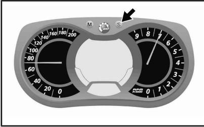
Le symbole suivant apparaît lorsque le mode altitude est sélectionné.
