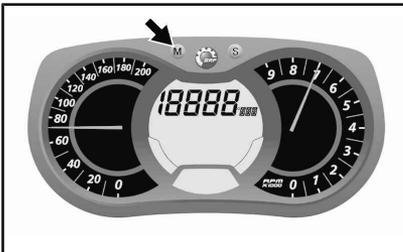
Pour réinitialiser, appuyez sur le bouton MODE (M) pour sélectionner le mode.
