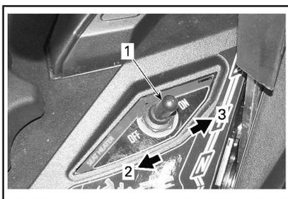
1. Commande de chauffage du siège
