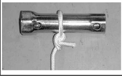
3. Attachez l'autre extrémité de la corde d'urgence à l'attache de démarrage de la trousse d'outils.
