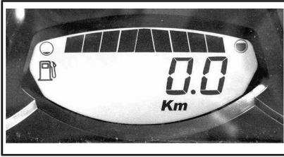
**REMARQUE :** Le mode entreposage ne fonctionne pas dans d'autres modes (distance A, distance B et compteur horaire).
