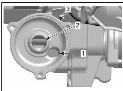
1. Orifice d'entrée de l'huile sous pression refoulée par la pompe à huile
