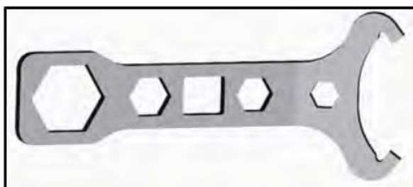
*STRUMENTO DI REGOLAZIONE DELLE SOSPENSIONI*
