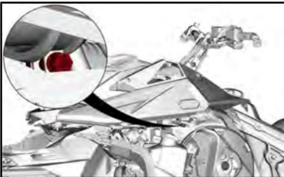
9. Rimuovere le viti che fissano il modulo superiore della carrozzeria su entrambi i lati.
