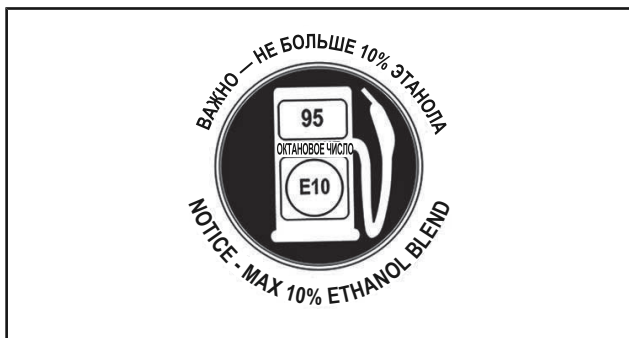
НА КРЫШКЕ ТОПЛИВНОГО БАКА — В СТРАНАХ, ГДЕ ИСПОЛЬЗУЕТСЯ ОКТАНОВОЕ ЧИСЛО RON
