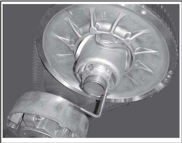
TYYPILLINEN – VARIAATTORIN AVAUSTYÖKALU ASENNETTUNA SÄÄTIMEN NAPAAN
