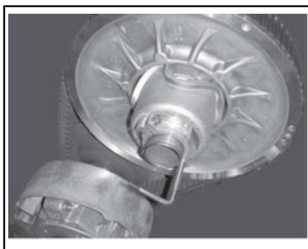
VARIATORNS UTVIDGARE INSTALLERAD PÅ JUSTERINGSNAVET
