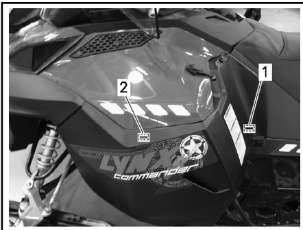
НА ЗАЩИТНОМ КОЖУХЕ ВАРИАТОРА — НАКЛЕЙКА 2
