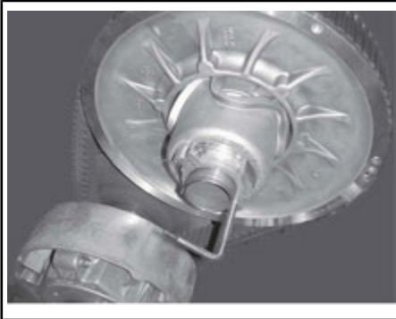
SCHEIBEN-EXPANDER AN NABE DER EINSTELLVORRICHTUNG MONTIERT
