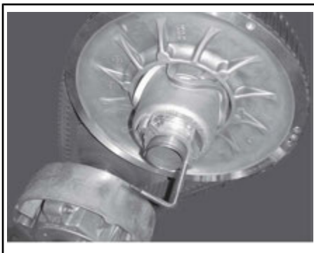
VARIATORNS UTVIDGARE INSTALLERAD PÅ JUSTERINGSNAV I ALUMINIUM
