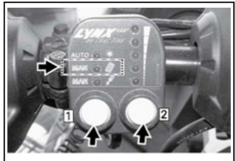
Zum Anpassen der Federvorspannung drücken Sie den linken Knopf, bis die LED MAN/Federung Abbildung aufleuchtet. Zum Einstellen der Vorspannung drücken Sie den rechten Knopf. Nach oben wird die Vorspannung erhöht und nach unten verringert.
